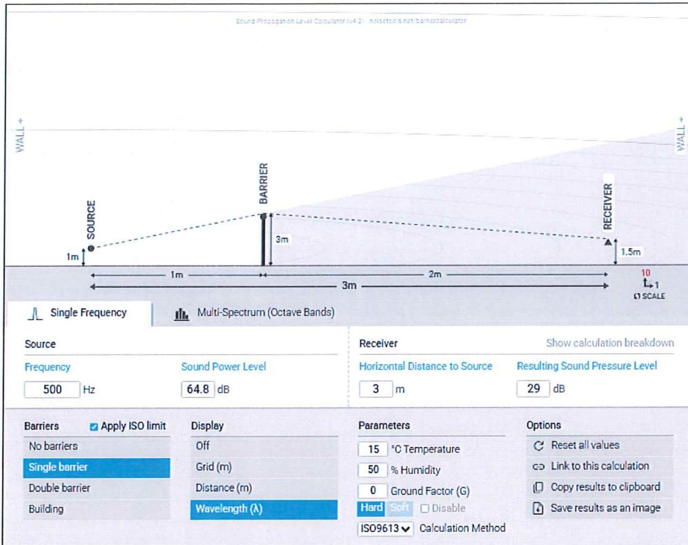
Nivelul de zgomot estimat la 1 m pe trotuar (str. Transilvaniei), este de 29.8 dB ca aport la fondul existent (cu usa inchisa).
